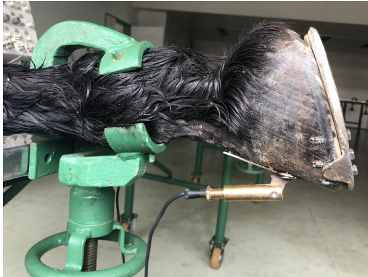
Abbildung 14: Befestigung des toten Hufs in der Vorrichtung
