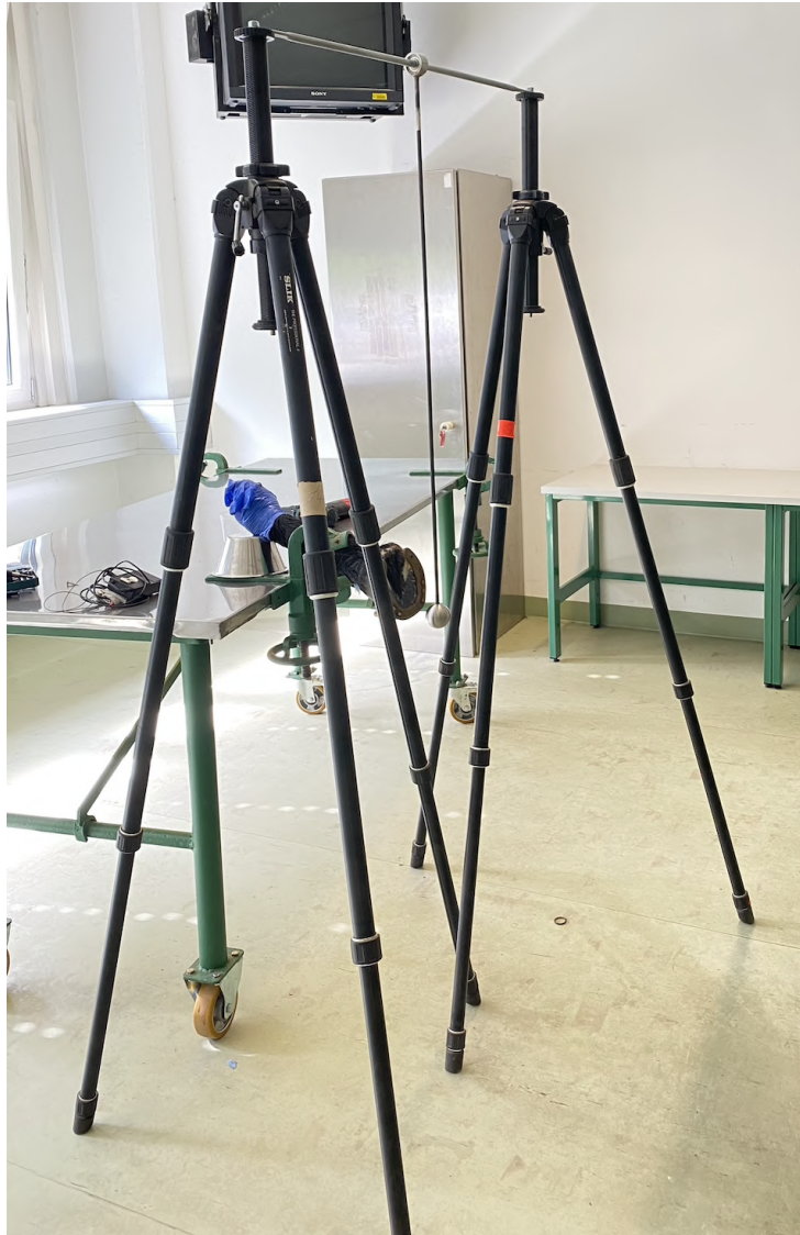
Abbildung 13: Positioniertes Pendel auf den Fotostativen
