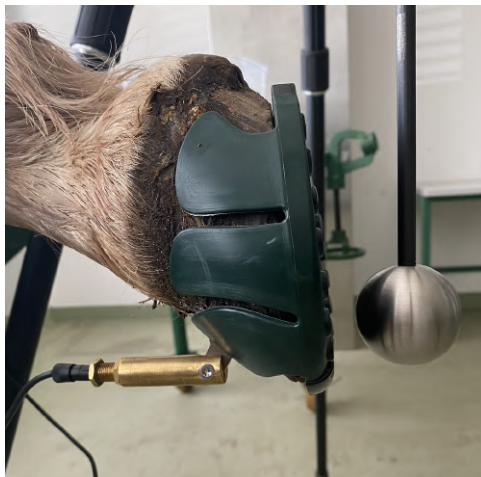
Abbildung 17: Nahaufnahme des Pferdehufs, ausgestattet für die Messung mit einem Klebebeschlag
